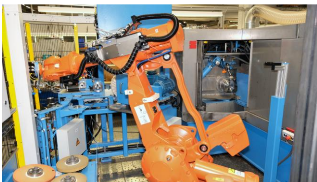
Peripherie-Schleifmaschine mit automatischer Roboter-Be- und -Entladung
