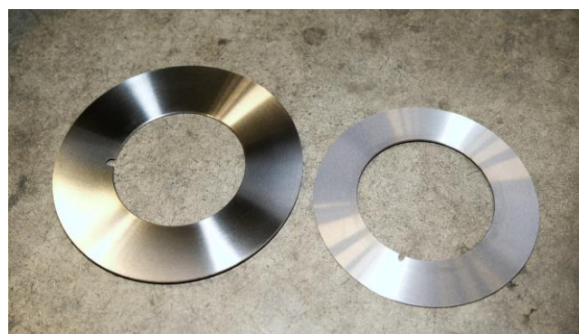
Flächenschliff an Rundmessern mit 5° Winkel
